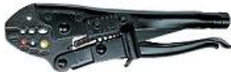
Kabelschuh - Presszange
