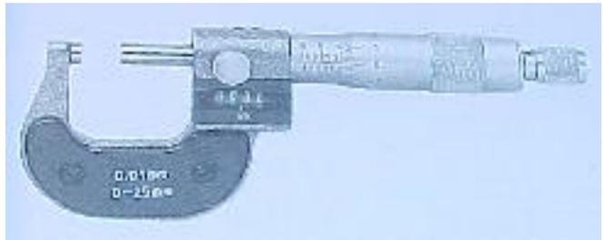
Außen - Mikrometer
