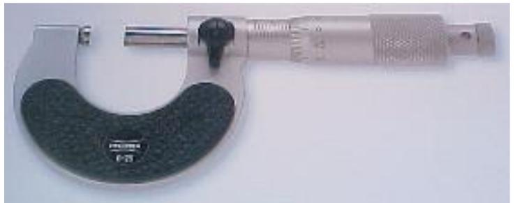
Außen - Mikrometer
