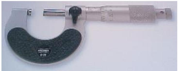
Außen - Mikrometer
