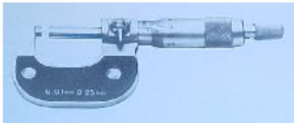
Außen - Mikrometer
