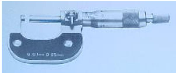
Außen - Mikrometer
