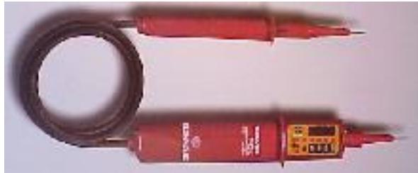
Spannungs - Durchgangs - und Phasenprüfung
