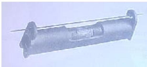
Schnur - Wasserwaage
